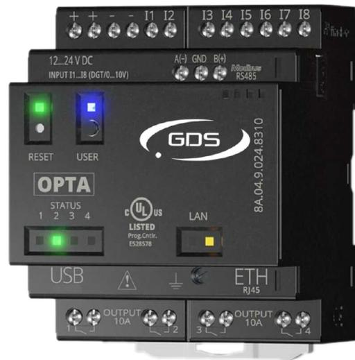
In aggiunta al pilotaggio dei moduli GD Service, il server può essere programmato per inviare stringhe HTML personalizzate, utili per pilotare altri apparati sulla rete LAN che trasmettano contenuti e supportino un protocollo di muting.
